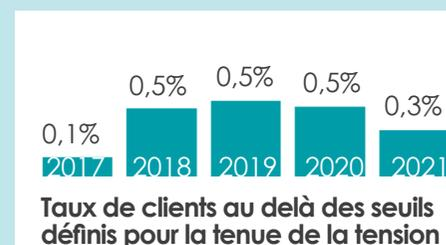
Un client est considéré comme mal alimenté lorsque la tension sort de la fourchette (-10% à +10%) de la tension nominale de 230 V.
